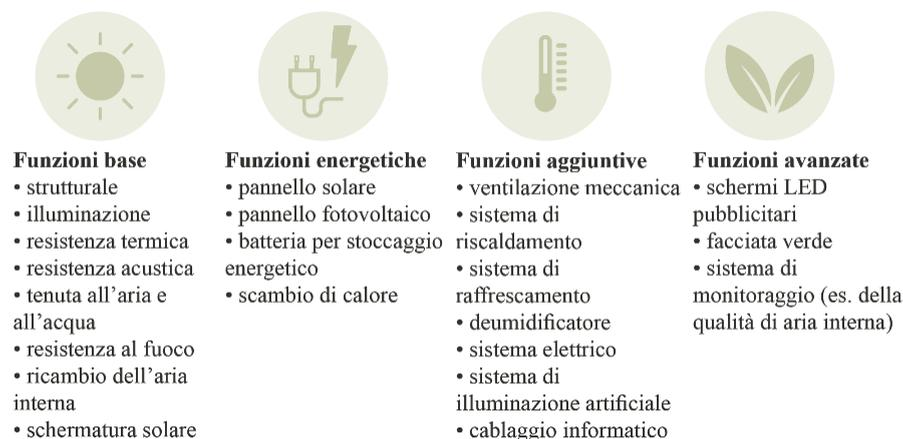
Fig. 34 – Funzionalità integrate all'elemento di facciata fornita con la logica di prodotto-servizio (fonte: rielaborazione dell'autore da Azcarate-Aguerre et al., 2018)
