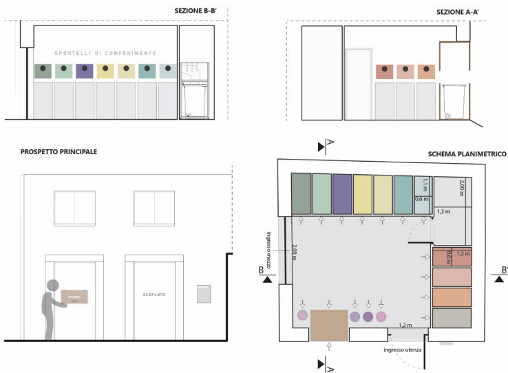
Fig. 6 - Elaborati progettuali relativi al prototipo di ecopunto fisso di prossimità all'interno di un immobile disabitato. (Immagine elaborata dall'Arch. Marco Bellia.)
