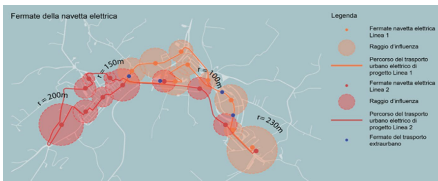
Fig. 7 - Il trasporto pubblico urbano: percorsi e raggi di influenza. (Immagine elaborata dall'Arch. Valentina Amato.)
