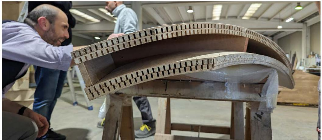
Fig. 4. Modello fisico per l'indagine dei processi di costruzione e la consecutiva digitalizzazione. Elaborazione degli autori.
