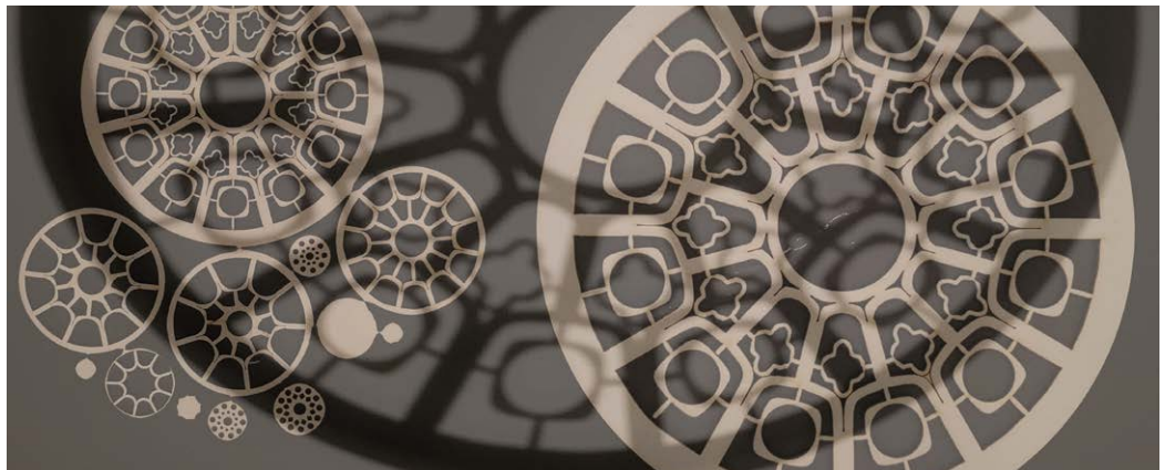
Sperimentazione dello script per la fabbricazione digitale dei prototipi in MDF. Immagine di Mara Capone.
