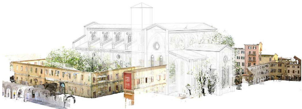
Chiesa di Sant'Agostino - Padova. Sovrapposizione del modello BIM della ricostruzione storica con il rilievo digitale attuale dell'area. Elaborazione dell'autrice.
