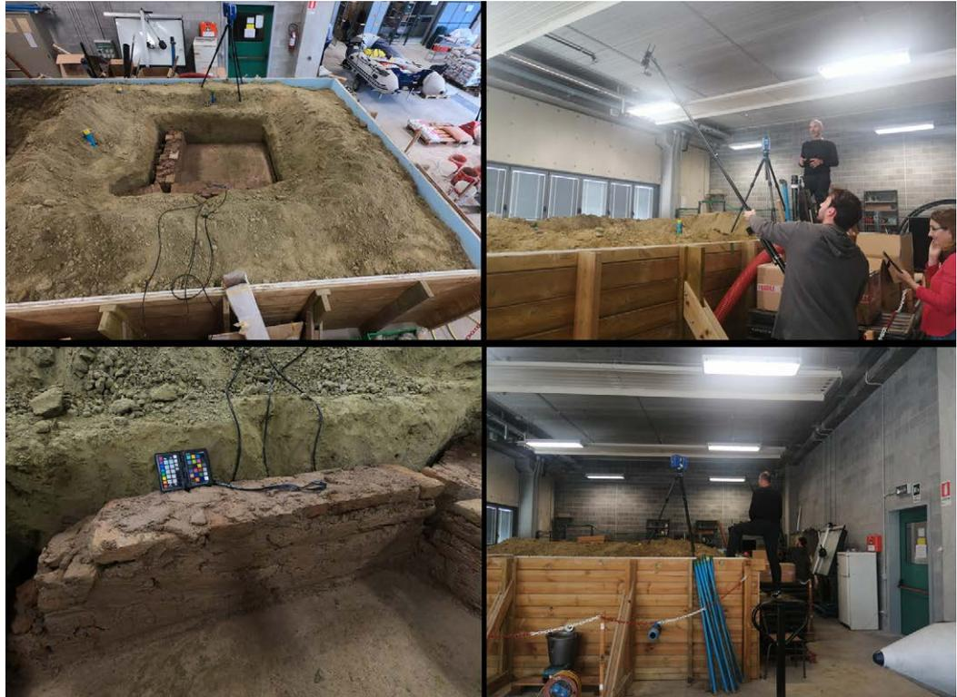
Fig. 5. Sequenza delle operazioni di rilievo con lo scanner Faro Focus3D X330 e asta telescopica Neutech Onair CI08. Nel corso della sperimentazione è stato testato anche il sistema ColorChecker.
