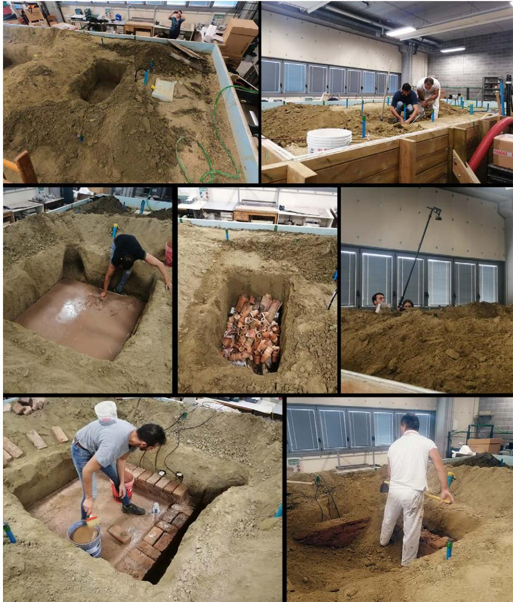
Fig. 2. Sequenza delle operazioni di scavo, costruzione dei reperti e successiva copertura con il materiale sabbioso.
