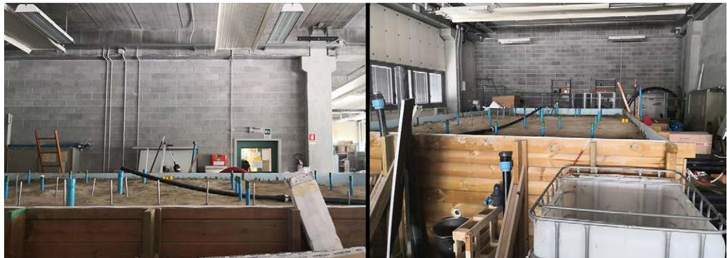
Fig. 1. Vasca di 50 m<sup>3</sup> contenente sedimenti della pianura ferrarese prima dell'avvio delle lavorazioni.
