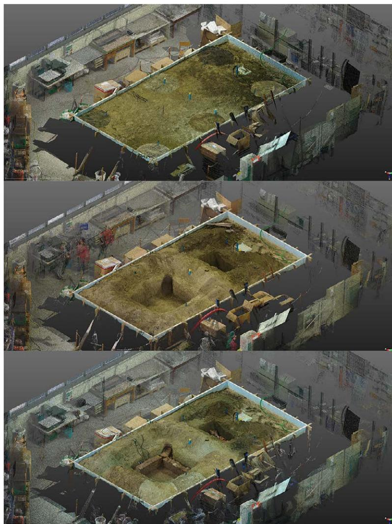
Fig. 7. Vista della nuvola di punti nelle tre fasi successive del rilievo in ambiente Trimble RealWorks.
