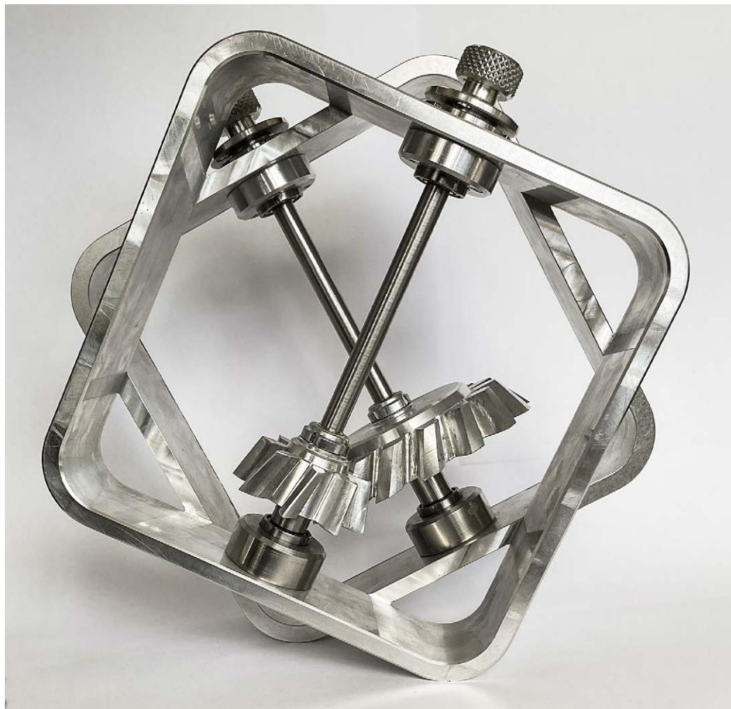
Fig. 9. Prototipo realizzato in alluminio e acciaio. L'impiego di porzioni di iperboloidi lontane dal punto di minima distanza tra gli assi di rivoluzione induce sforzi assiali che vengono dissipati tramite l'utilizzo di cuscinetti a sfera obliqui, montati in configurazione contrapposta.
