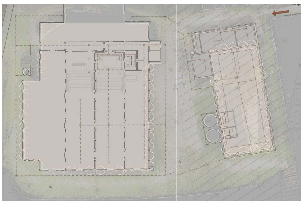
Fig. 8. Teatro India, sovrapposizione del disegno di archivio in pianta e della nuvola di punti. Disegno archivio DSDRA - Rilievo architettonico scala 1:200. Corso di Scienza della Rappresentazione III, studenti M. Caramella, F. Castelli, G. Decandia, a.a. 2005/2006, disegno cad. (ARDISCont 5.1). Elaborazione degli autori.
