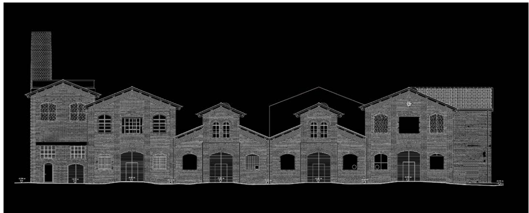
Teatro India, prospetto sud dell'edificio principale. Disegno archivio DSDRA - Rilievo architettonico scala 1:100. Corso di Scienza della Rappresentazione III, studenti M. Caramella, F. Castelli, G. Decandia, a.a. 2005/2006, disegno cad. (ARDISCont 5.9). Elaborazione degli autori.
