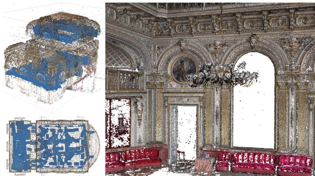
Fig. 4. Rilevo fotogrammetrico. Punti di acquisizione degli scatti fotografici e vista prospettica della nuvola di punti. Elaborazione degli autori.
