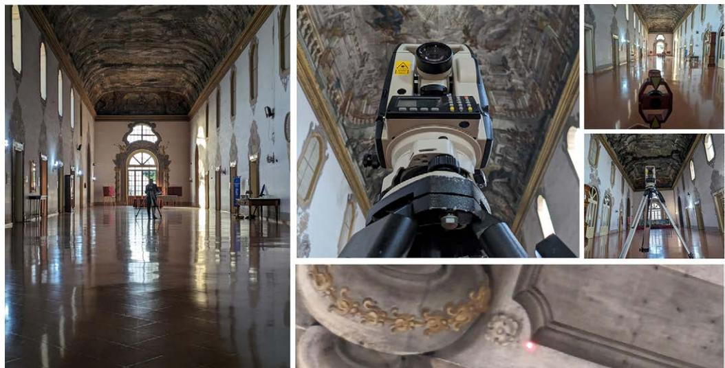
Fig. 6. Documentazione fotografica della fase di campagna tramite TPS. Punto di stazionamento e dettagli. Elaborazione degli autori.
