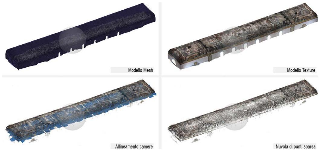
Fig. 9. Modelli puntiformi e poligonali ottenuti a seguito della correzione delle deformazioni. Elaborazione degli autori.
