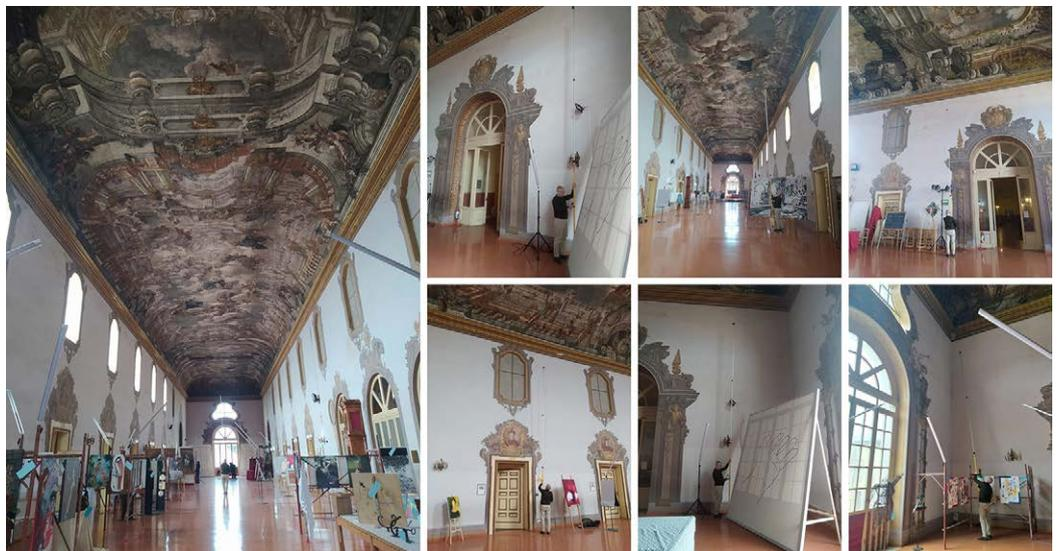
Fig. 5. Documentazione fotografica della fase di campagna fotogrammetrica. Riprese in dinamico tramite Actioncam posta su base telescopica. Elaborazione degli autori.
