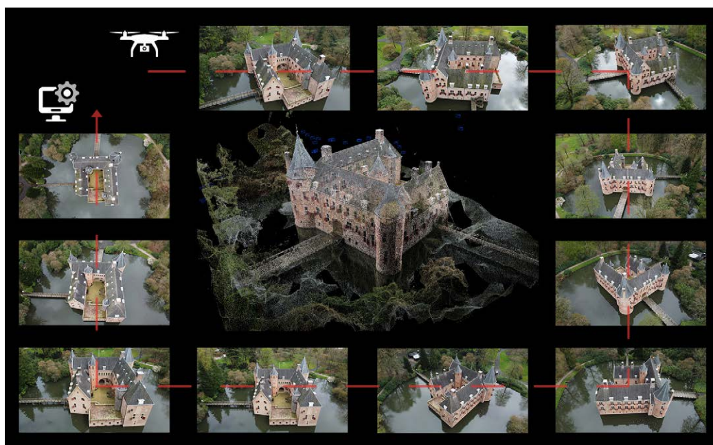
Fig. 6. Tecniche di ripresa di fotogrammetria aerea. Schema di volo e sovrapposizione del 70% per rotazione ad assi convergenti. Elaborazione dell'autore.
