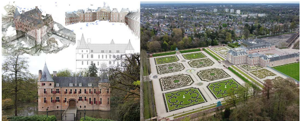
Le residenze reali degli Orange, workflow del processo fotogrammetrico, dalla nuvola dei punti al disegno bidimensionale. Elaborazione dell'autore.
