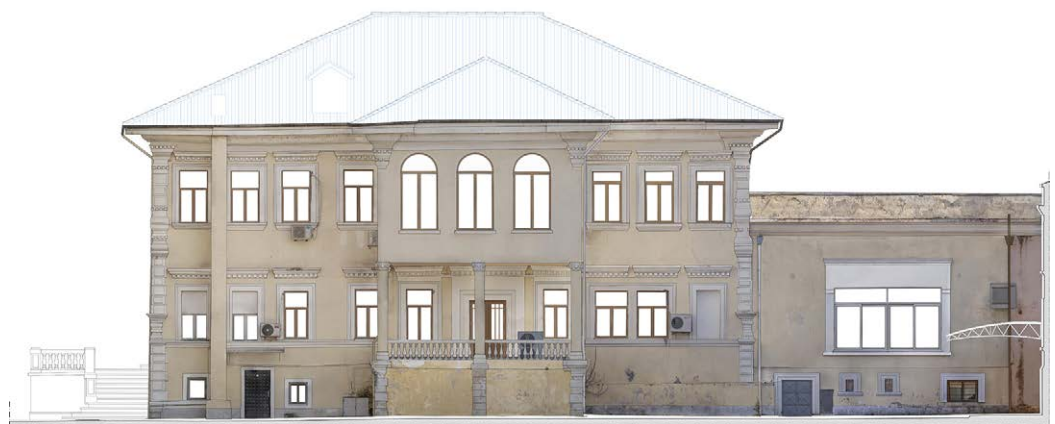
Fig. 6. Fotopiano del fronte Ovest. Elaborazione di CHM_lab.
