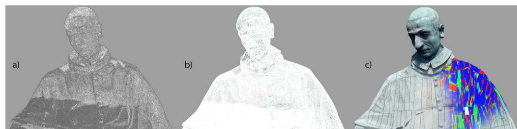
Fig. 6. Processo modellativo: a) dalla nuvola di punti a b) modello mesh e c) NURBS e analisi della curvatura (Gaussiana). Elaborazione degli autori.
