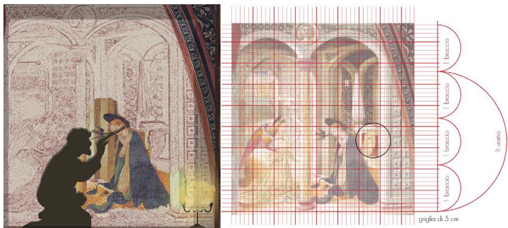
Fig. 11. Ipotesi di quadrettatura impiegata da Delitio dedotta sulla base di tracce di sinopia rinvenute nel rilevamento. Elaborazione dell'autrice.
