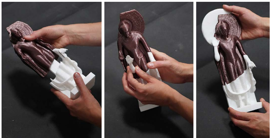
Fig. 3. Buddha replica tattile stampata in 3D: montaggio delle parti. Elaborazioni dell'autrice.
