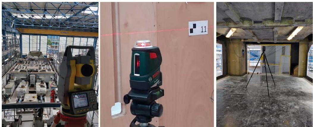
Fig. 4. Fasi di acquisizione della barca attraverso stazione totale, livella laser e laser scanner 3D. Elaborazione degli autori.
