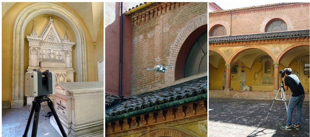
Fig. 6. Fasi di acquisizione geometrica con laser scanner 3D RTC360, drone e fotogrammetria da terra. Foto degli autori.
