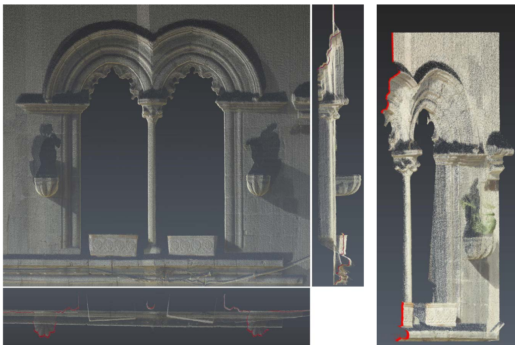
Fig. 10. Rilievo della bifora del centro storico di Savoca (ME). Sezione assonometrica. Modello 3D dalla nuvola di punti. Elaborazione degli autori.
