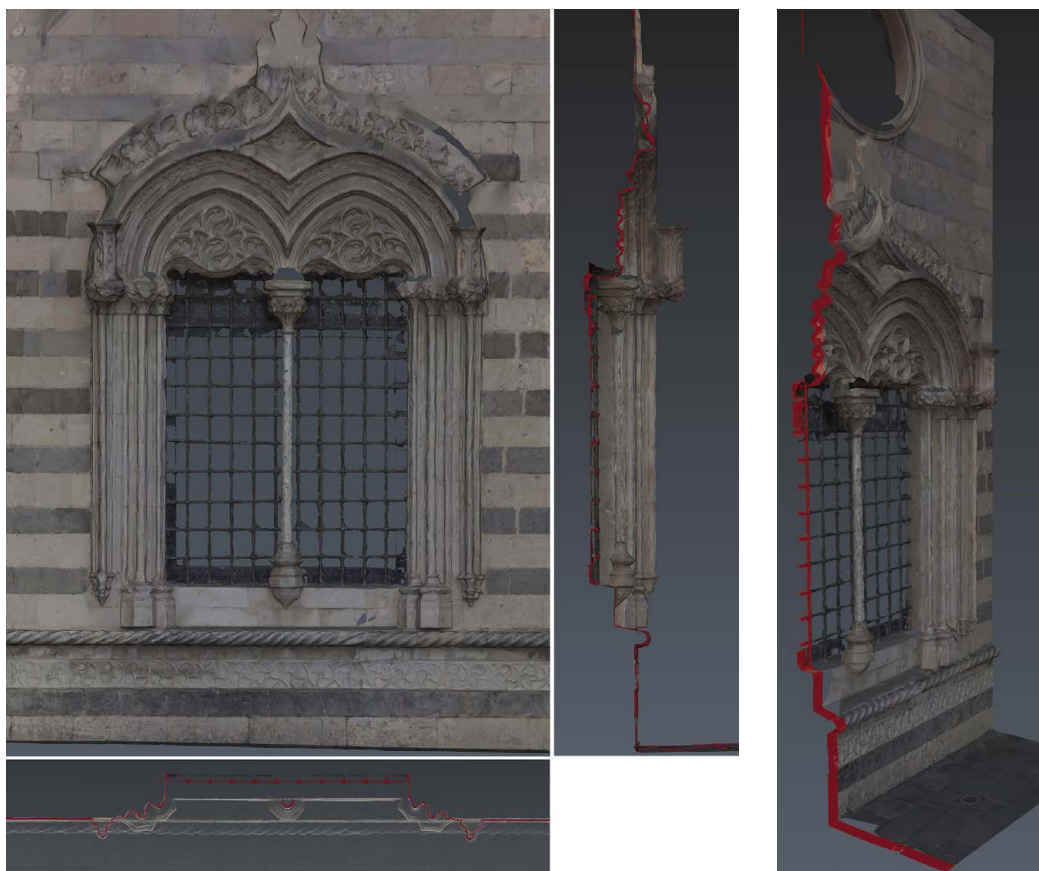
Fig. 3. Rilievo della bifora del Duomo di Messina. Modello 3D dalla nuvola di punti con mesh: alzato, pianta e sezione verticale. Elaborazione degli autori.
