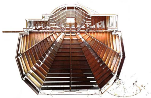
Fig. 5. Livelli informativi dell'Archivio Kühtz Chiesa di San Giovanni Battista: pianta dell'orditura principale del tetto in legno lamellare da nuvola di punti laser al disegno di progetto dell'autore. Elaborazione di F. Strippoli.
