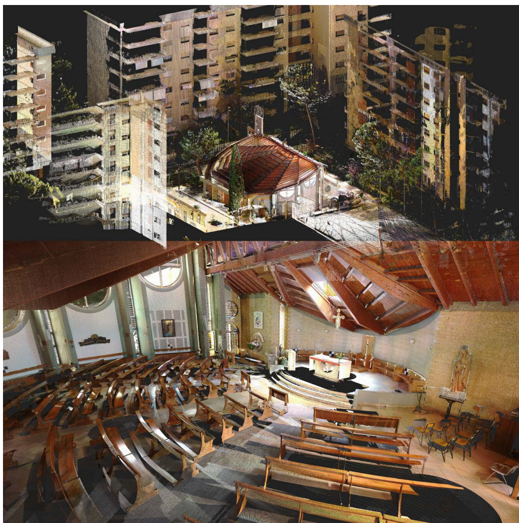
Fig. 4. Implementazione di nuovi dati nell'Archivio Kühtz. Chiesa di San Giovanni Battista: modello tridimensionale della chiesa da nuvola di punti laser scanner. Elaborazione di F. Strippoli.
