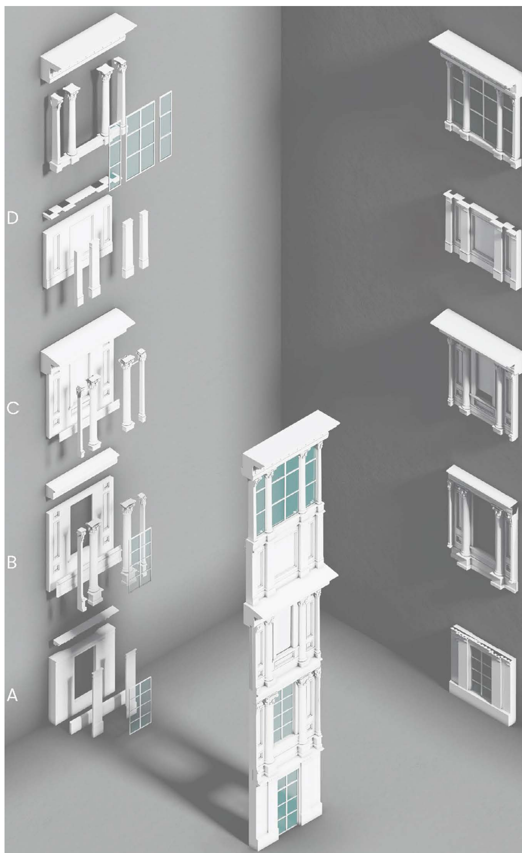
Fig. 7. "Modello dinamico" di una parte della facciata che si sviluppa su 5 livelli con esploso delle sotto-componenti. Elaborazione di L. Torresi.
