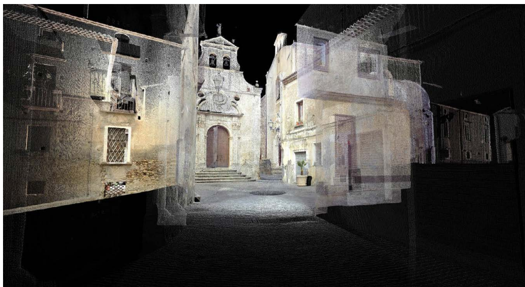
Fig. 6. La Chiesa dell'Addolorata, modello numerico derivante dall'elaborazione di scansioni laser. Elaborazione degli autori.
