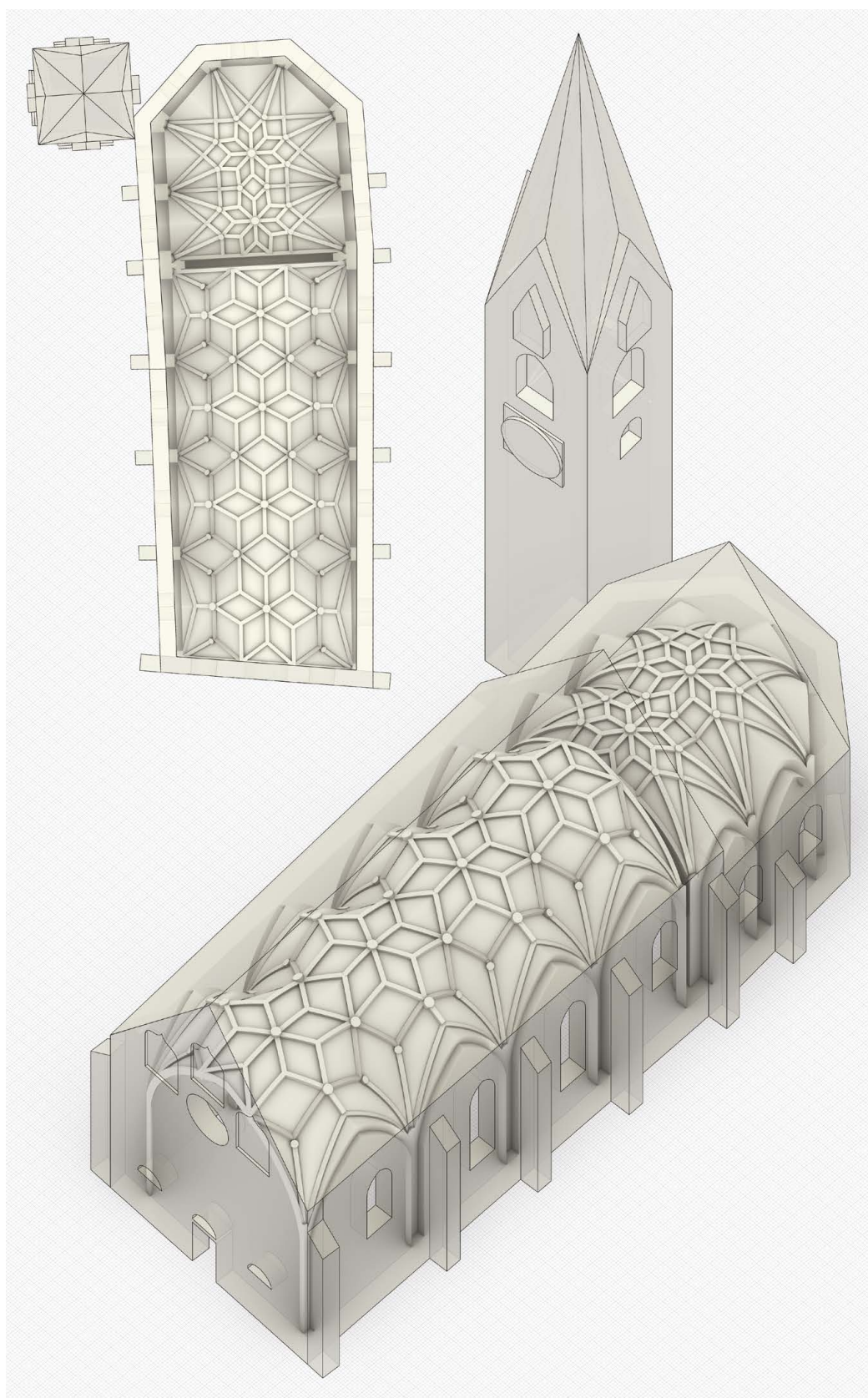
Fig. 8. Ipotesi ricostruttiva del sistema voltato basata sulle evidenze dei dati di rilievo e sull'osservazione dei sistemi voltati tipologicamente affini. Planta e vista assometrica. Elaborazioni degli autori.
