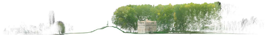
Fig. 2. Sezione a scala paesaggistica del modello digitale a nuvola di punti della Rocca Possente di Stellata. Elaborazione degli autori.
