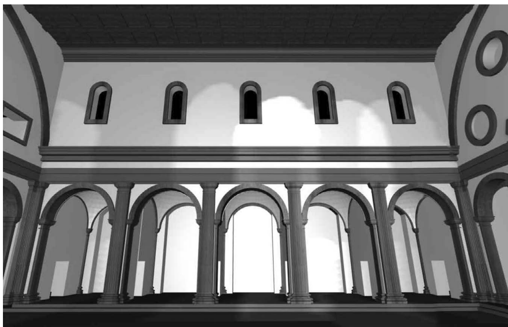
Fig. 10. Chiesa di San Gallo. Ipotesi ricostruttiva dell'interno, vista sulle cappelle, copertura a cassettoni, claristorio con monofore. Elaborazione di Ylenia Ricci.
