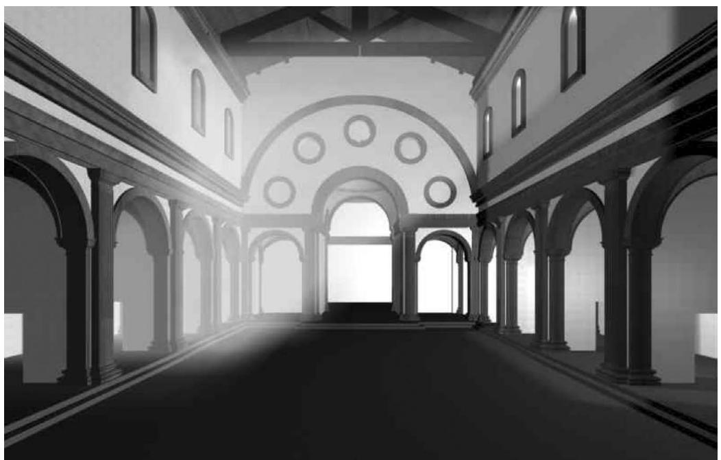
Fig. 9. Chiesa di San Gallo. Ipotesi ricostruttiva dell'interno, vista verso l'abside, copertura a capriate, claristorio con monofore. Elaborazione di Ylenia Ricci.
