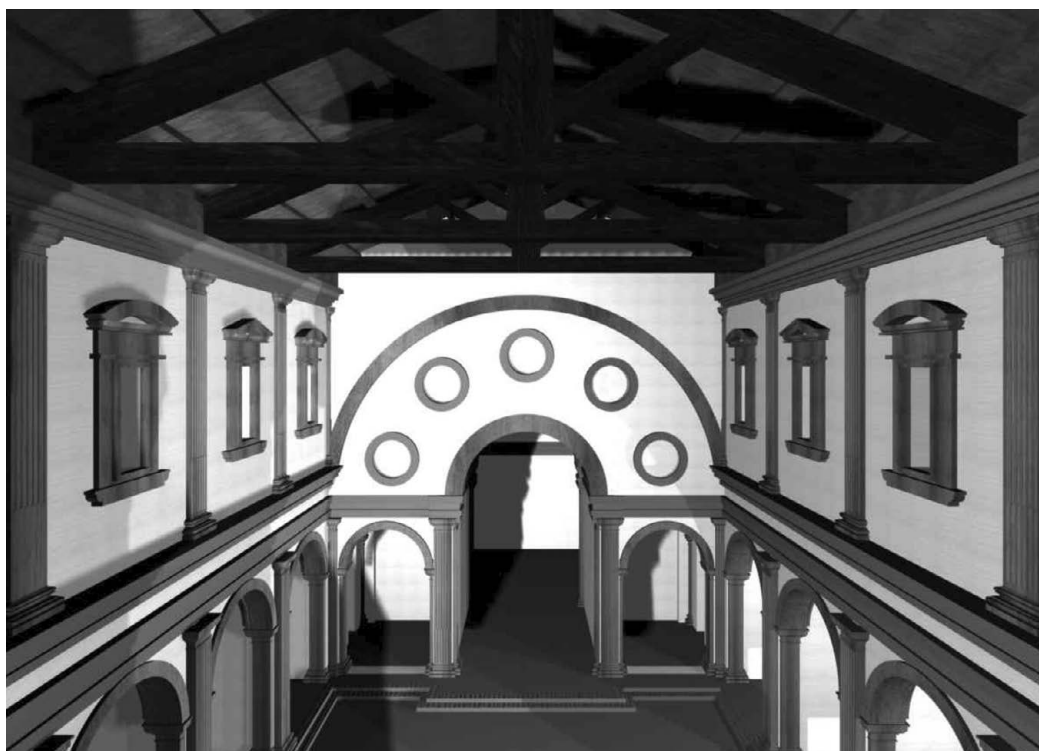
Fig. 11. Chiesa di San Gallo. Ipotesi ricostruttiva dell'interno, vista verso l'abside, copertura a capriate, claristorio con partito decorativo ispirato al San Salvatore al Monte. Elaborazione di Ylenia Ricci.
