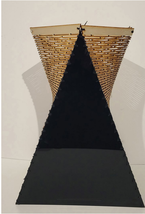
Fig.83/ I due triangoli in plexiglas consentono di costruire un sistema in equilibrio.
