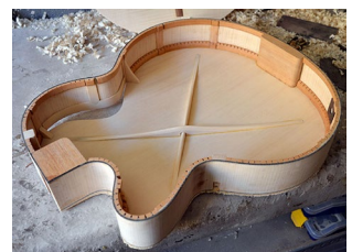
Fig. 2/ Kerfing tradizionale: in un pannello di un determinato spessore la curvatura dipende dalla larghezza, dalla profondità e dalla distanza dei tagli.
