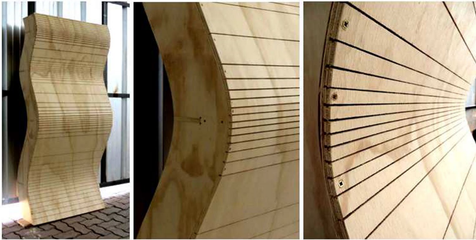
Fig.24/ Distribuzione ottimizzata su superfici a singola curvatura: tecnica tradizionale tagli su un solo lato. Prototipo di Loyola M. et al. 2017.
