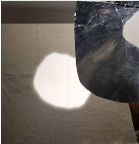
Fig.51/ Tangenziale intersezione. Prototipo 1_alluminio. Ombre e riflessioni: lo studio delle ombre restituisce la natura della superficie: la curva gobba intersezione di un paraboloide con un cilindro circolare, proiettata ortogonalmente restituisce l'immagine del cerchio di base.
