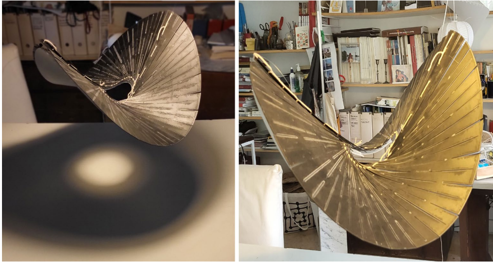
Fig.53/ Prototipo 2_polipropilene. Tangenziale intersezione. Applicando un pattern di taglio al polipropilene le tensioni si annullano.
