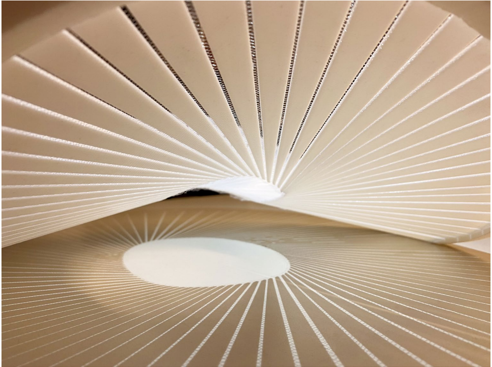
Fig. 54/ Prototipo 3_PLA stampa su tessuto. Sperimentazione per la costruzione del prototipo con tecnica di fabbricazione additiva e tessuto. Dettaglio.
