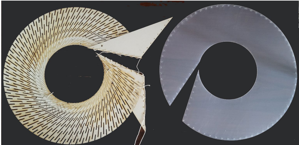
Fig. 33/ Elicoide sviluppabile. Prototipo 1.2_multistrato _ polipropilene. Dalla forma piana alla costruzione del prototipo.
