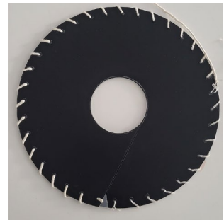
Fig. 26/ Elicoide sviluppabile. Prototipo 1.1_polipropilene. Il prototipo costruito con un pannello di polipropilene 0.2 mm è tanto più elastico minore è la dimensione del prototipo.
