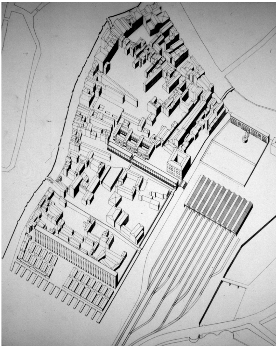
Fig. 28/ Assonometria generale con il sistema architettonico progettato da Aldo Rossi: Il grande albergo, un grande «filtro» che dà accesso al sestiere; immediatamente dietro, la ricostruzione del Fondaco dei Tedeschi, il blocco lineare dell'edificio per uffici e dell'edificio a corte per uffici e attività commerciali. A destra, la nuova stazione, con l'albergo su Canal Grande che guarda verso la città. © Archivio Progetti luav.
