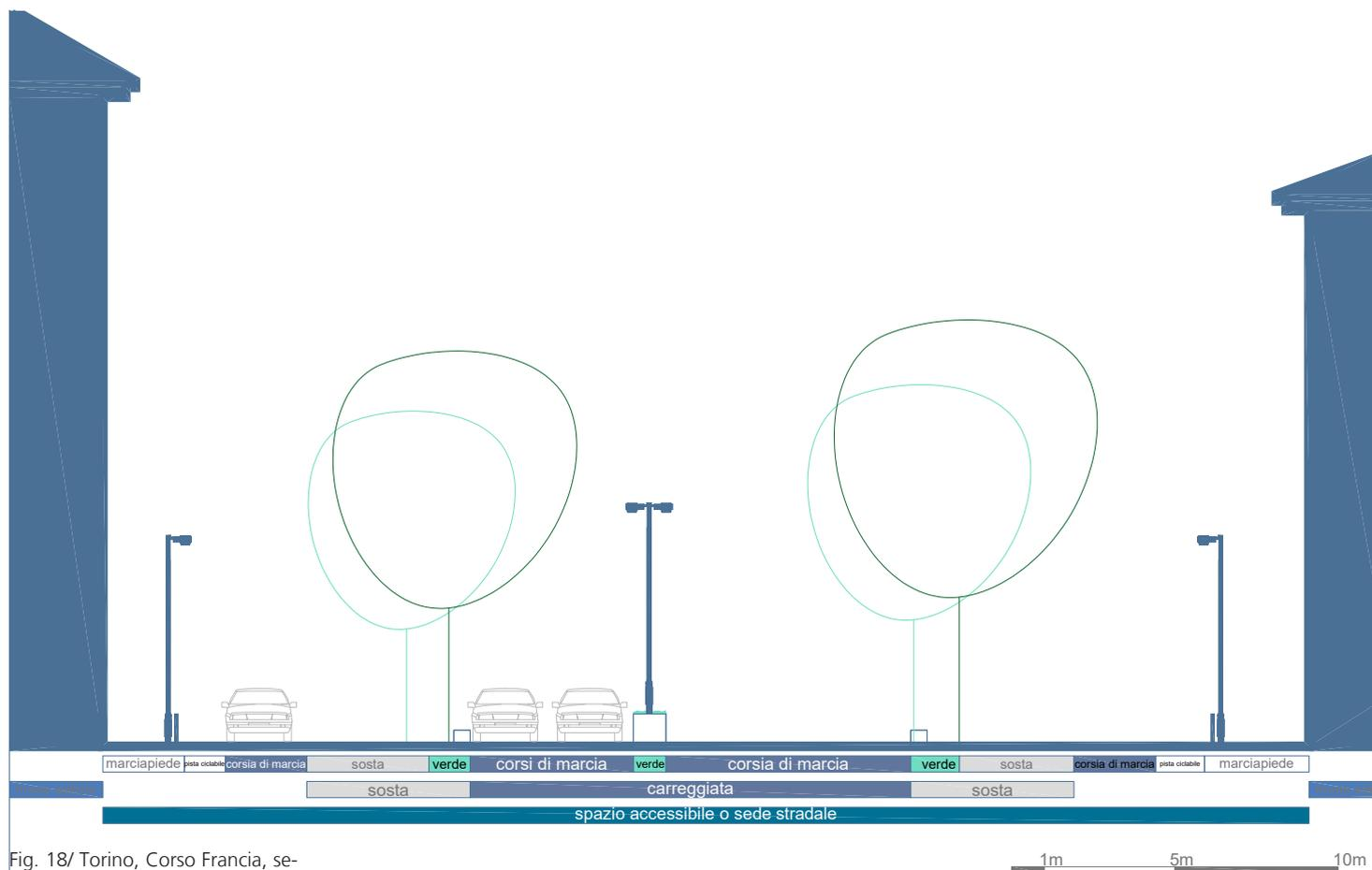
Fig. 18/ Torino, Corso Francia, sezione stradale, dove l'intero spazio accessibile è privo di dislivelli, I marciapiedi in prossimità dei fronti edilizi sono separati dalle corsie di marcia mediante la pista ciclabile. All'interno della sezione stradale sono stati inseriti anche degli elementi verdi che rendono il viale alberato molto piacevole.
