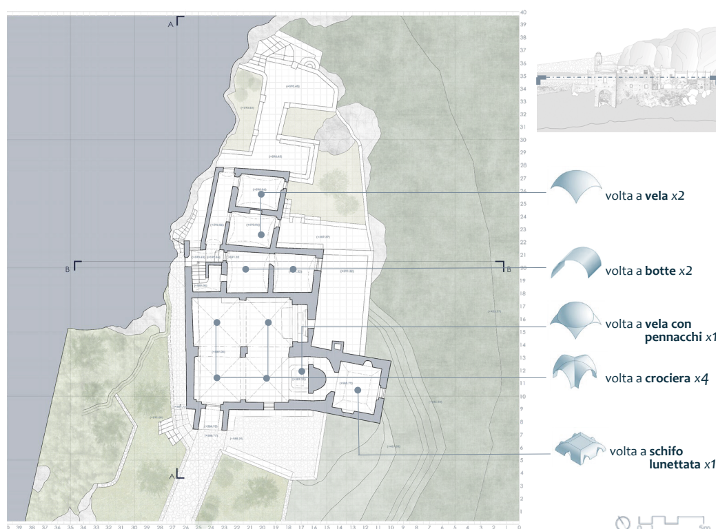
Fig. 9. Mappatura dei sistemi voltati di copertura dell'Eremo di Cetrella (immagine a cura degli autori con C. Crati).
