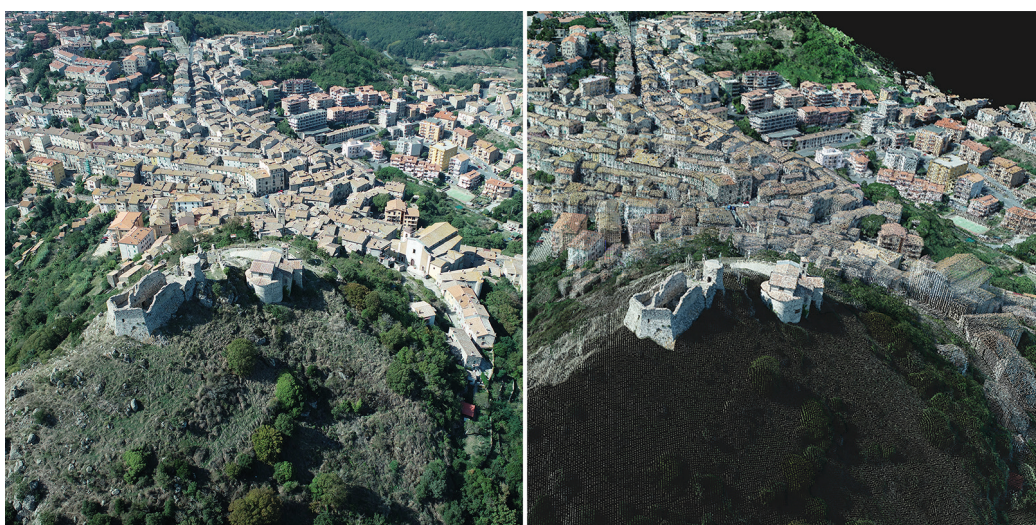
Fig. 10. A sinistra, veduta di Tolfa dalla rocca dei Frangipane. Foto effettuata da G. Fioravanti con la camera montata sul drone. Sulla destra, vista del modello 3D nuvola di punti.
