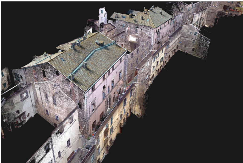
Fig. 6. Nuvola di punti dei fronti e della copertura di Palazzo Panetti, insieme a una porzione di via Annibal Caro, realizzata attraverso l'integrazione di dati acquisiti con fotogrammetria aerea, LiDAR e laser scanner (elaborazione degli autori).
