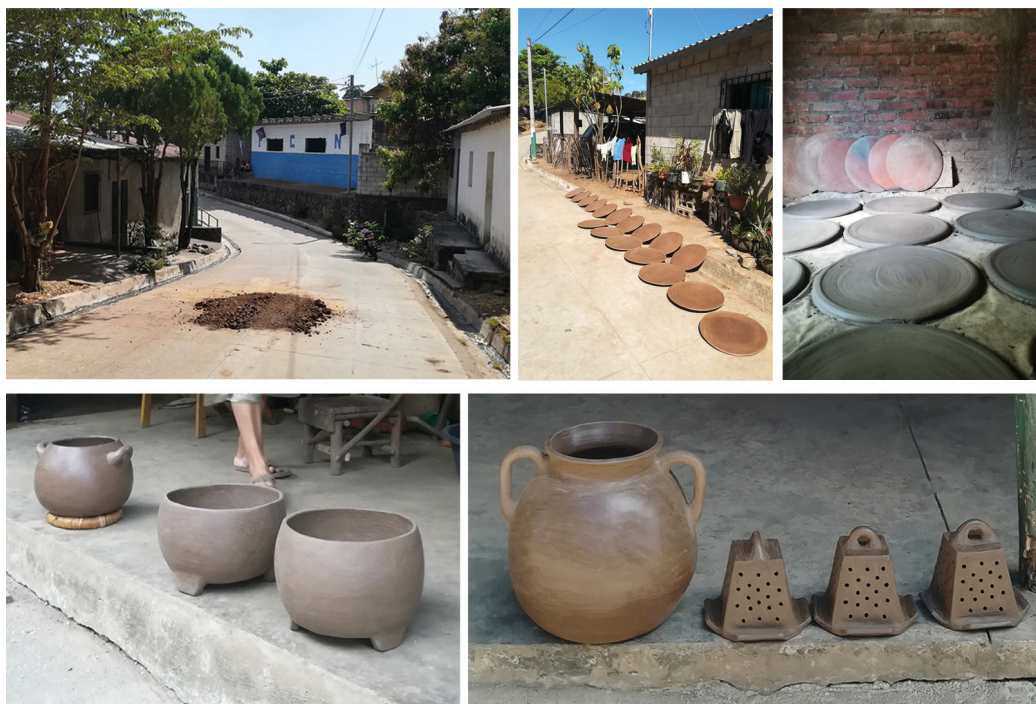
Fig. 6. Fasi di produzione dei manufatti di barro rojo. Pestato del barro, lavorazione, essiccazione e cottura in forno (fotografie degli autori).
