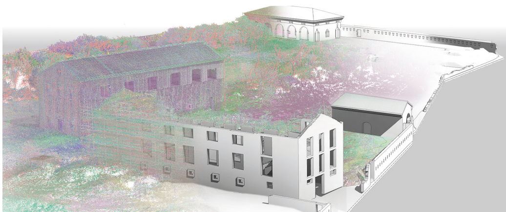
Schema concettuale del processo scan-to-BIM di restituzione del modello parametrico.
