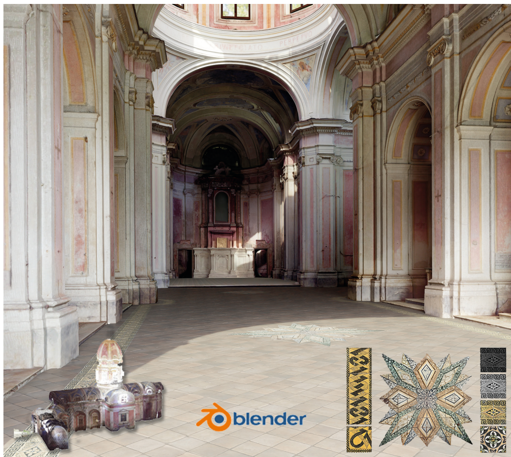
Fig. 9. Dal modello nuvola di punti (a cura di R. laderosa) al modello digitale esplorabile elaborato con una fase di sculpting per zone parzialmente occluse come dettagli della pavimentazione maiolicata e di alcune cappelle (a cura di C. Di Rienzo).
