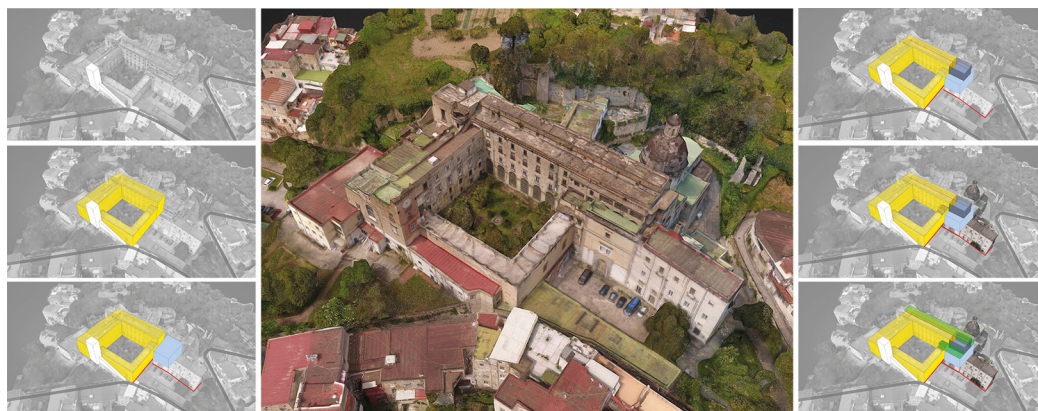
Fig. 2. Ipotesi delle fasi architettoniche del complesso di Santa Maria della Vita, dall'impianto di fondazione cinquecentesco ad oggi (a sinistra e a destra), condotto sulla base di documenti di archivio, rilievo digitale integrato e documenti testuali (a cura di V. Cirillo). Al centro uno scatto da drone del complesso monastico (di R. Carrelli).
