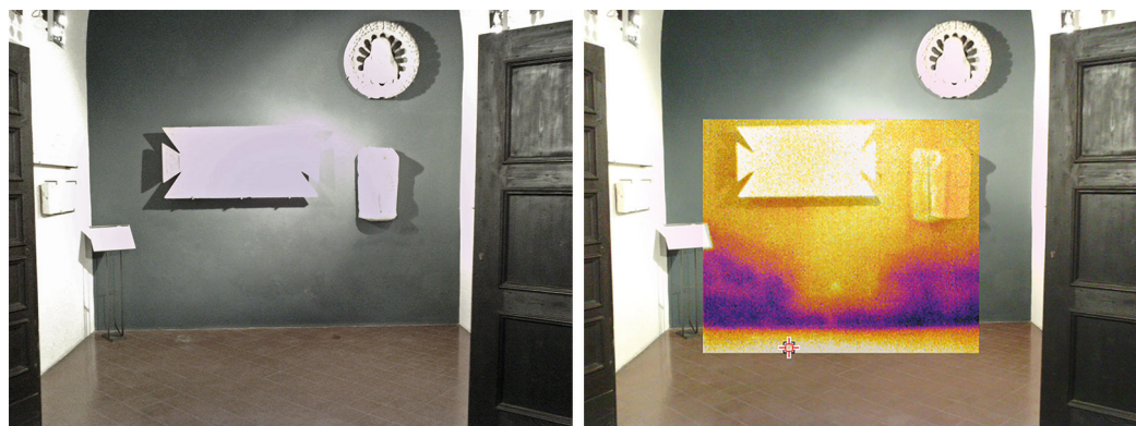
Fig. 11. Rilievo termografico con sovrapposizione dei due canali, RGB fotografico e termografico, acquisiti dallo strumento. Si può notare la presenza di un'apertura sotto lo strato di intonaco.
