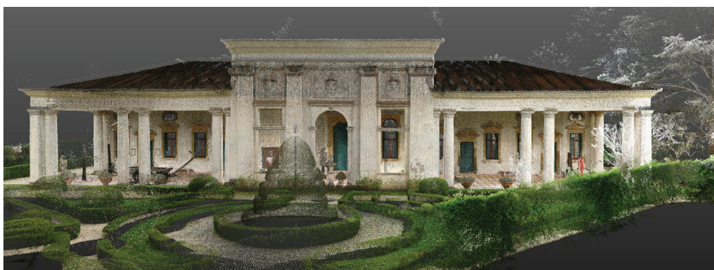
Fig. 3. Nuvola di punti ottenuta tramite laser scanner, Villa Valmarana (elaborazione grafica degli autori).
