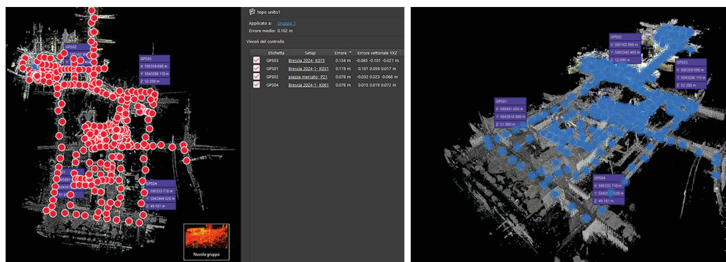
Fig. 8. A sinistra: applicazione delle coordinate di controllo dei vertici acquisiti con sistema GNSS e con lo scanner ed errori di rototraslazione evidenziati; a destra, vista assonometrica della distribuzione dei vertici doppi acquisiti con tecniche scanner e satellitari (elaborazione grafica degli autori).
