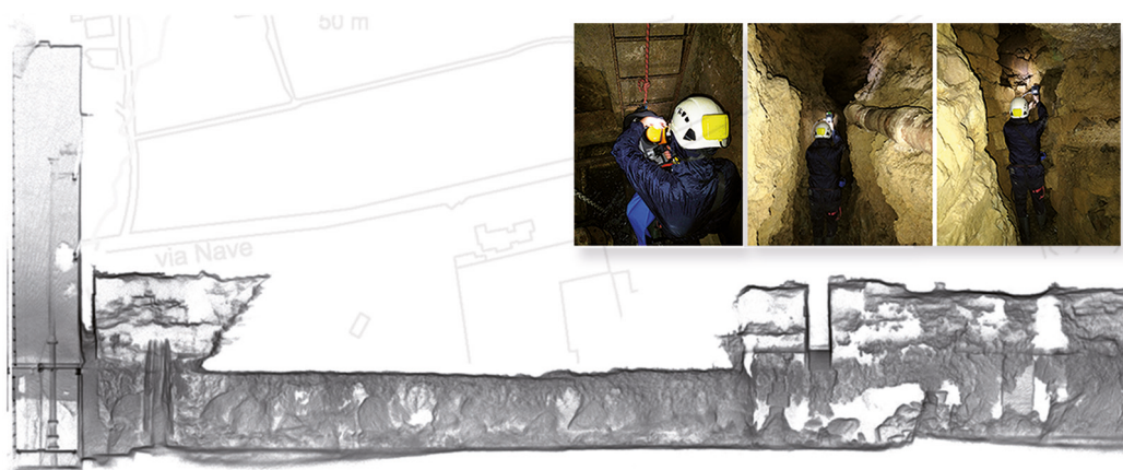
Scansione 3D del ‘Corso Gesuitico alto’ con tecnologia SLAM.
