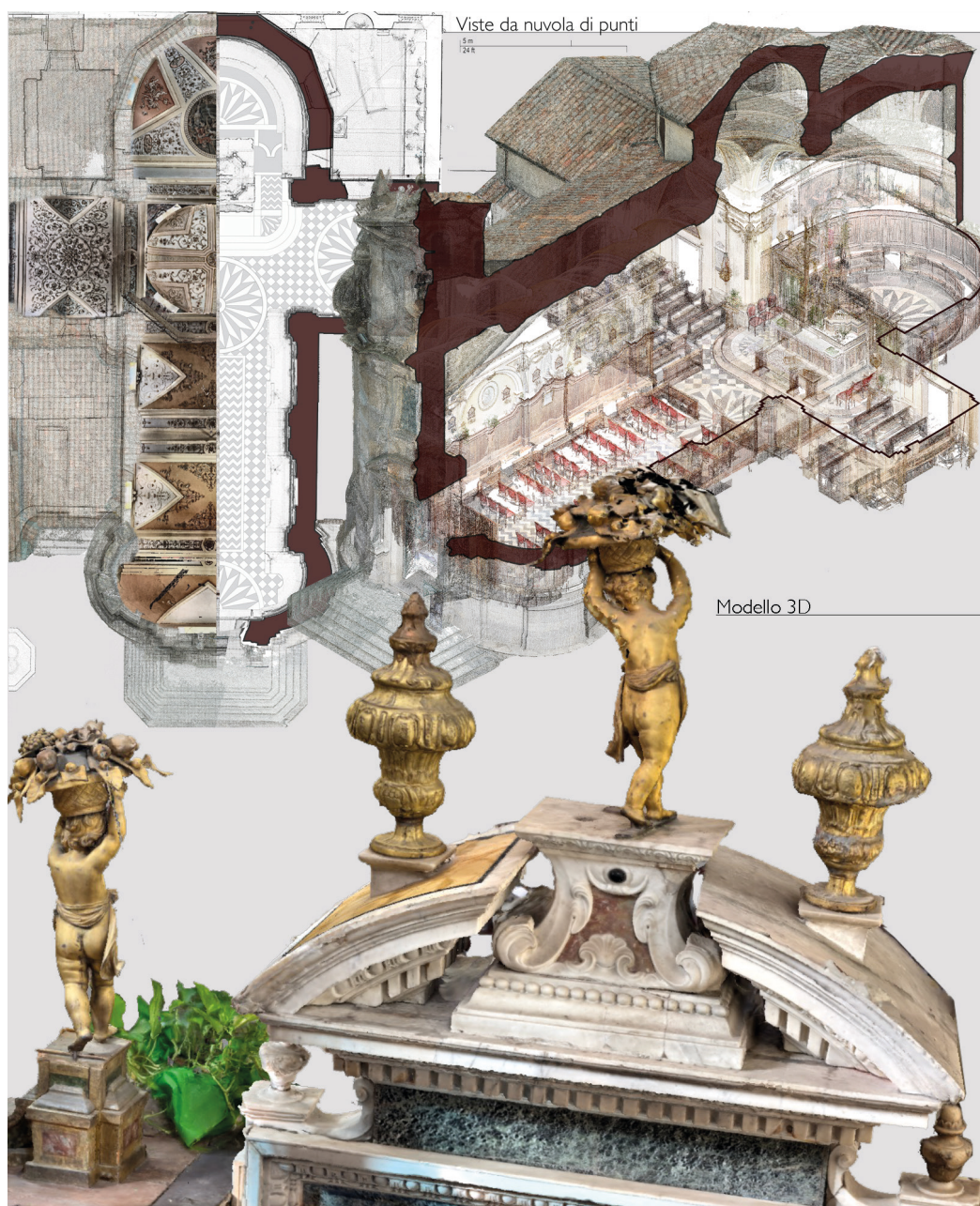
Fig. 5. In alto: modello 3D dedotto dall'integrazione di acquisizioni da laser e da fotogrammetria digitale; in basso: dettaglio del modello fotogrammetrico riferito all'altare maggiore.
