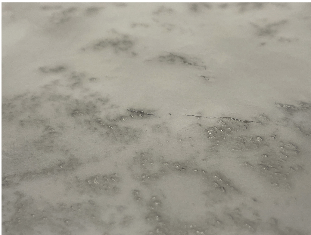
Fig. 6 Calco n. 536a, dettaglio della superficie della carta traslucida nella quale si riscontrano lievi ondulazioni (fotografia degli autori).
