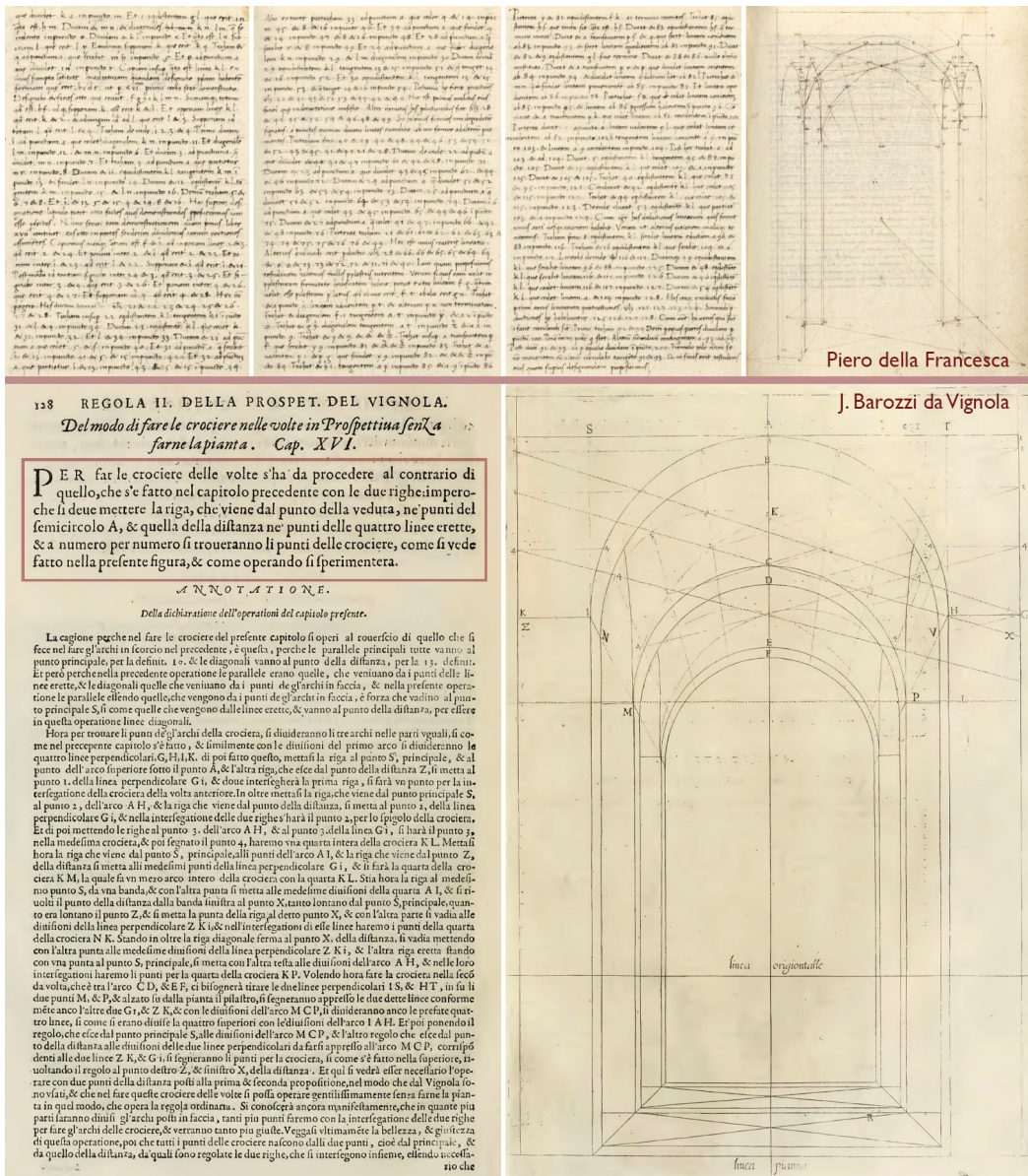
Fig. 2. Descrivere il disegno: rapporto fra testo e immagine per la rappresentazione di una volta a crociera nel De prospectiva pingendi di Piero della Francesca (in alto) e nel Le due regole di Vignola (in basso). Vignola (testo nel riquadro) affida quasi totalmente alla figura il compito di evocare il processo costruttivo.
