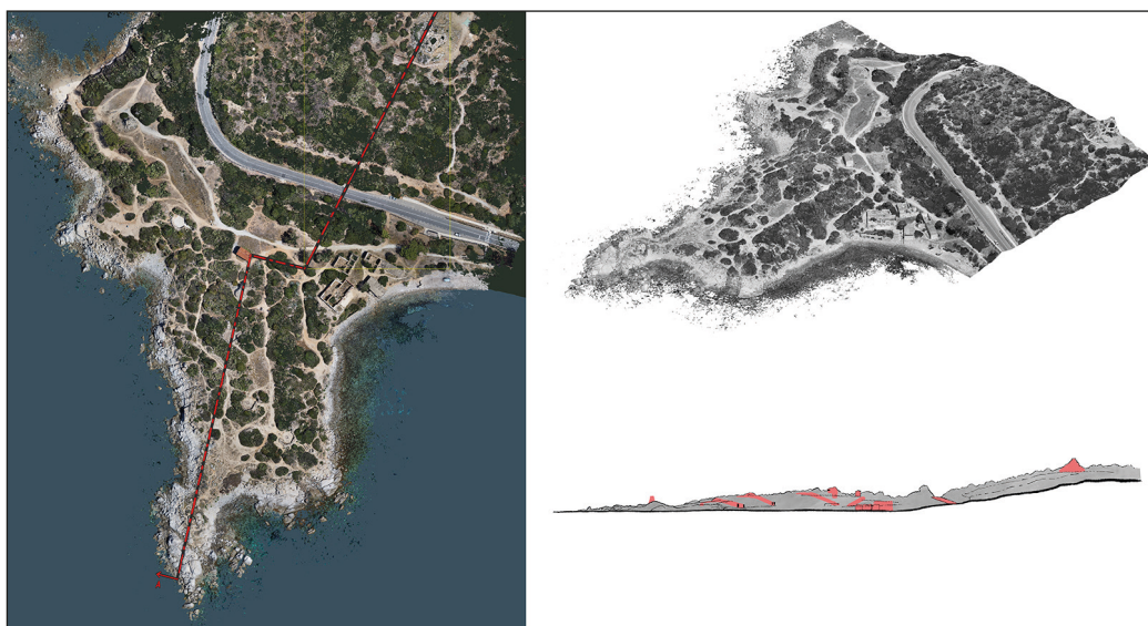
Fig. 10. Promontorio di Is Mortorius; rilievo fotogrammetrico e rappresentazione attraverso viste zenitali e profili che mostrano le strutture fuori terra e le parti interrate della batteria (rilievo e elaborazione grafica a cura di N. Paba, A. Pirinu e G. Sanna).
