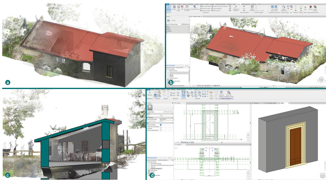
Fig. 5. Modellazione parametrica del mulino: procedura Scan-to-BIM (a); modello dello stato di fatto (b); sezione sul canale in muratura (c); creazione di famiglie parametriche per le aperture (d) (elaborazione grafica degli autori).
