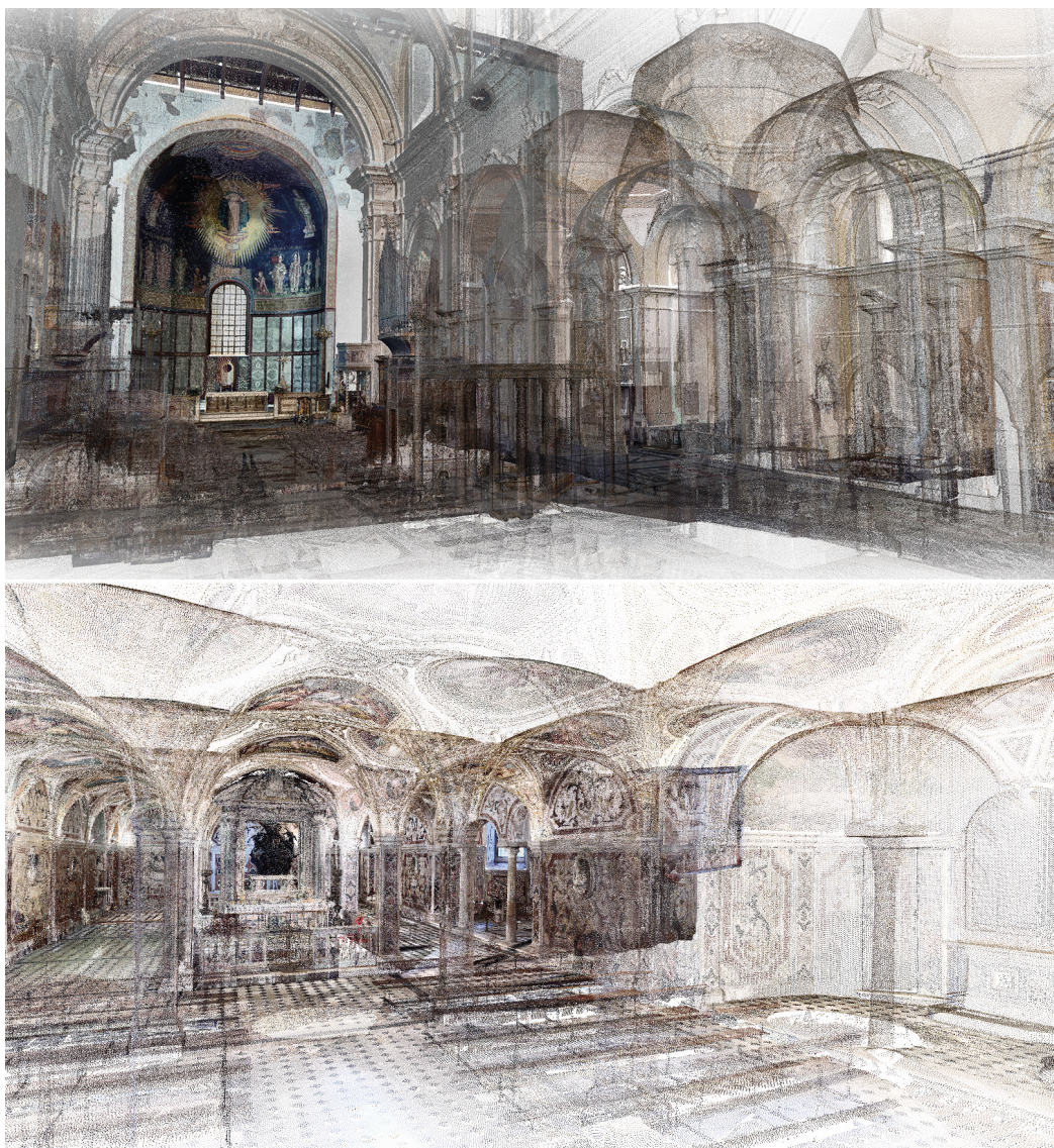
Fig. 3. Nuvole di punti, da Terrestrial Laser Scanning , degli interni del Duomo di Salerno (basilica superiore e cripta). Rilievi effettuati dal gruppo di ricerca del Laboratorio Modelli-Surveying and Geo-Mapping for Environment and Cultural Heritage, Università degli Studi di Salerno (giugno 2024).
