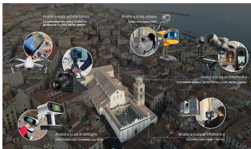
Fig. 2. Le tecnologie di rilievo digitale impiegate per la generazione del database informativo multi-scala: il laser scanner mobile SLAM ZEB Horizon FARO, il DJI Mavic Air 2, le camere D800E DSLR Nikon e la Ricoh Theta X, i laser scanner terrestri X330 e S 150 Plus FARO, lo scanner a luce strutturata Leo ARTEC.
