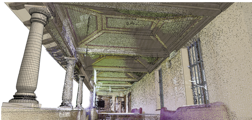
Fig. 9. Modello HBIM Certosa di Pesio. Screenshot modello sovrapposto a nuvola di punti (elaborazione degli autori).
