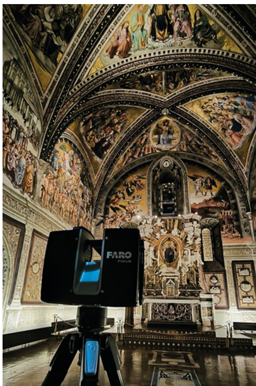
Fig.5 A sinistra: scansione della Cappella di San Brizio con Faro Focus S70. A destra: scansione della piazza del Duomo con NavVis VLX 3 (Immagini di proprietà degli autori).
