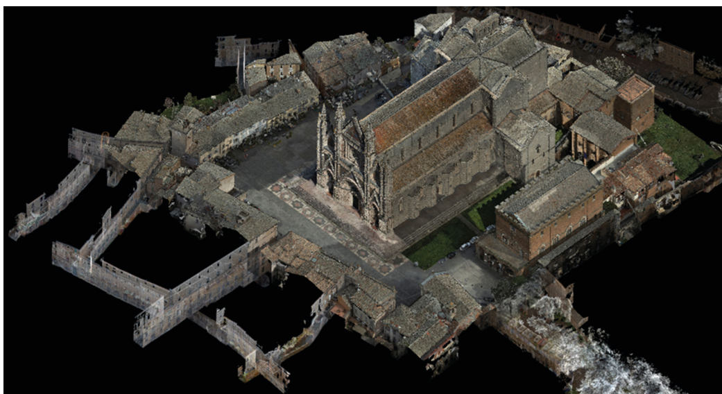
Fig.9 Risultato del rilievo integrato tra sistemi UAS (esterno Duomo), Faro Focus S70 (interno Duomo), NavVis VLX 3 (contesto) (immagine a cura degli autori).
