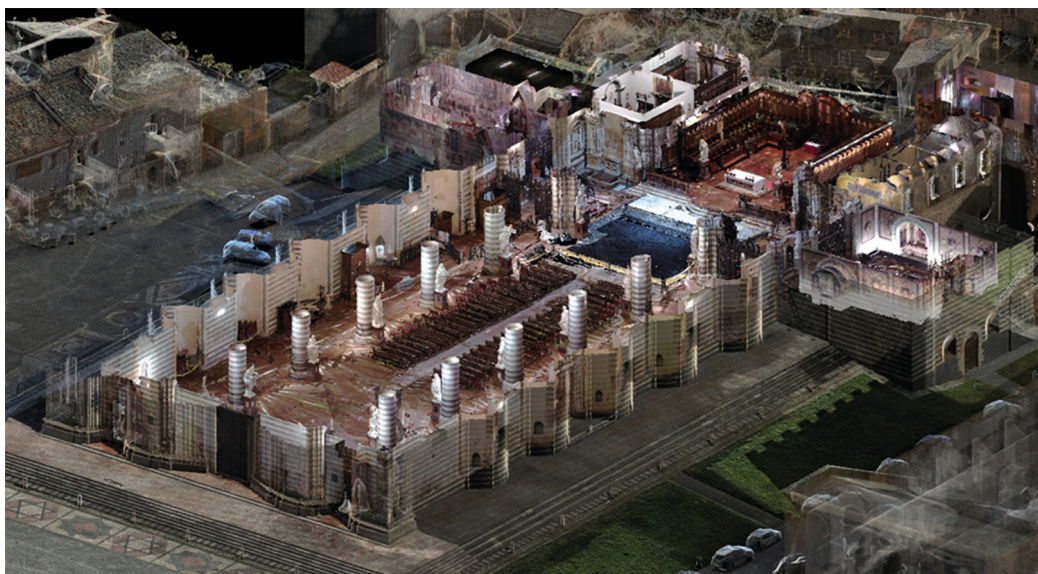
Fig. 7 Nuvola di punti densa che rappresenta l'interno del Duomo sezionato, scansionato tramite il laser scanner Faro Focus S70 inserito nel contesto di Orvieto acquisito con drone e NavVis VLX3 (immagine a cura degli autori).
