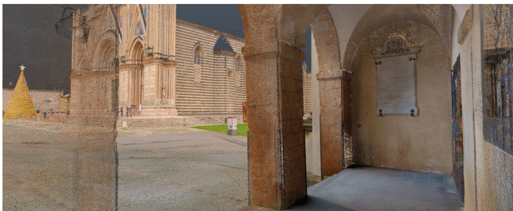
Nuvola di punti del contesto del Duomo di Orvieto generata con Laser Scanner Mobile NavVis VLX 3 (immagine a cura degli autori).
