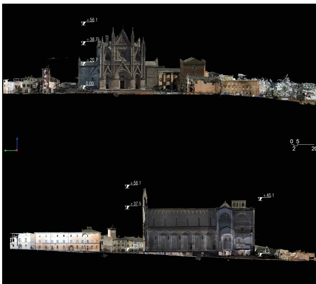
Fig. 12 Risultato del rilievo integrato tra Sistemi UAS (esterno Duomo), Faro Focus S70 (interno Duomo), NavVis VLX 3 (contesto). Prospetto - sezione con quote altimetriche e scala metrica (immagine a cura degli autori).
