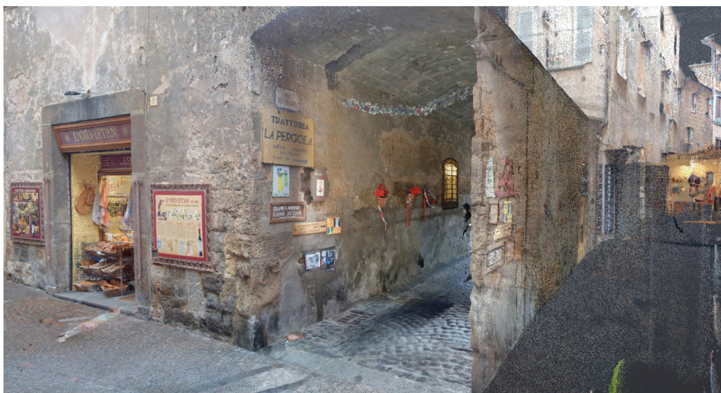
Fig.8 Nuvola di punti densa complessiva del centro storico di Orvieto e dettaglio di un vicolo generata dal rilievo effettuato con NavVis VLX 3 (immagine a cura degli autori).
