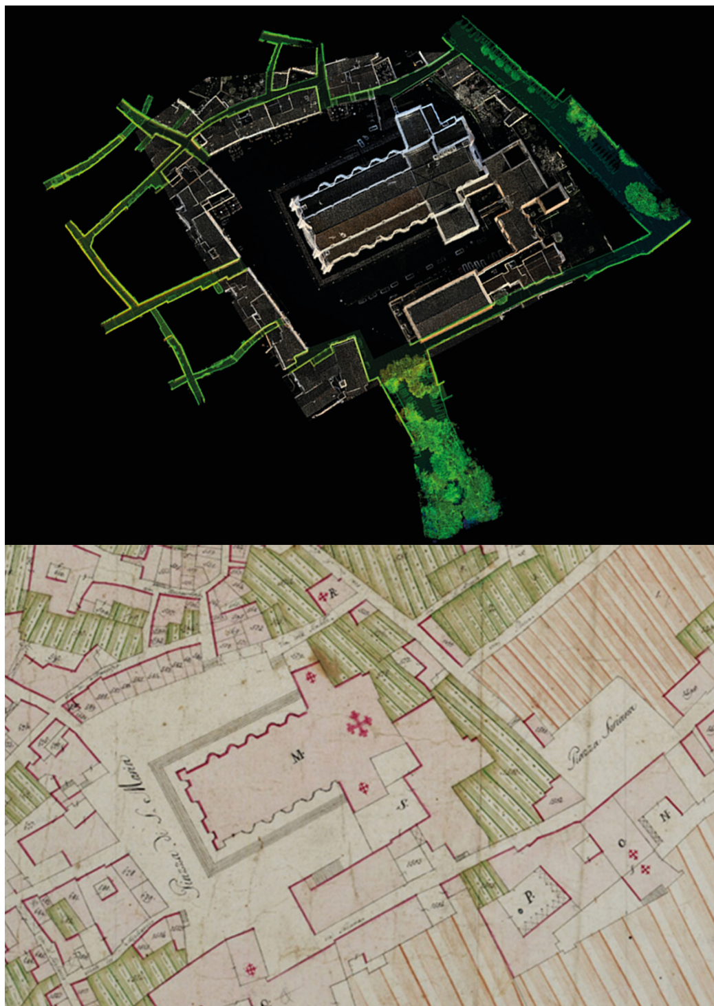
Fig.10 Risultato del rilievo integrato tra Sistemi UAS (esterno Duomo), Faro Focus S70 (interno Duomo), NavVis VLX 3 (contesto). A confronto con Primo catasto particellare dello Stato Pontificio, promosso da Pio VII nel 1816 e attivato da Gregorio XVI nel 1835. Dettaglio della tavola del Catasto Gregoriano del duomo di Orvieto. Fonte: immagine a cura degli autori e www.imagoarchiviodistatoroma.cultura.gov.it
