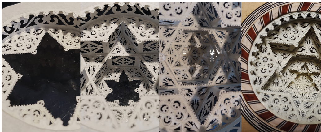
Fasi di realizzazione della rosetta in pergamena e cornice della buca sulla tavola armonica (foto dell'autore).
