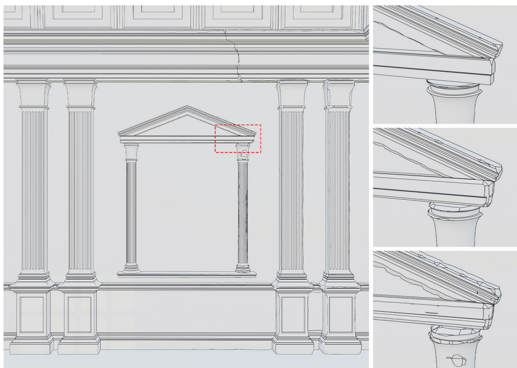
Fig. 9. Transizione verso un modello rovinato tramite edging . La parametrizzazione delle forme grazie all'uso del VPL permette una regolazione graduale di questo effetto (disegno degli autori).
