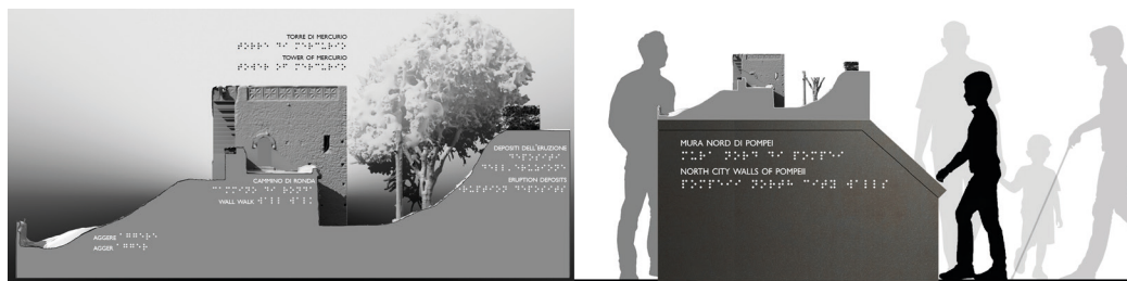
Fig. 10. Modello di fig. 9 in una sezione significativa che mostra l'andamento dei dislivelli del terreno con spiegazioni semplici degli elementi costituenti, anche nel sistema di scrittura tattile a rilievo Braille per non vedenti e ipovedenti e sistemazione del modello su supporto per la fruizione in uno spazio museale a cura di S. Bertacchi.
