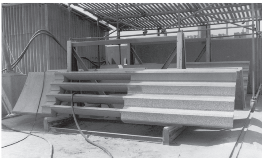
Fig. 2 - Il processo di finitura in stabilimento dei pannelli (AM, fondo IN.CO. S.p.A. e Silvano Zorzi, DOI: https://doi.org/10.24443/usi-arc-bib_FINC.48498 , ID immagine: 48498)
