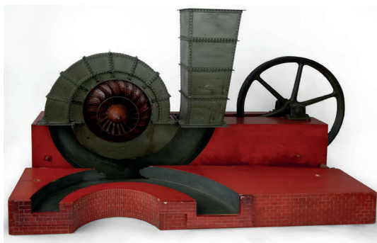
Fig. 20 - Modello didattico di ventilatore a turbine da miniera per estrarre l'aria viziata, metà XIX sec., modellatore R. Braun, collezioni DIATI, Politecnico di Torino.
