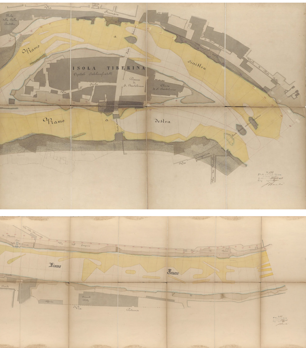
Fig. 2 – Progetto di appalto generale per la sistemazione delle due sponde del Tevere dalla casa Amoretti Antaldi alla Longara fino presso ai ruderi dei Bagni di Donna Olimpia sulla destra, e dal Vicolo dello Struzzo fino lo sbocco della Marrana di S.Giovanni sulla sinistra. Pianta dei ruderi da sgombrarsi da Ponte Rotto all'Emporio dei Marmio, 18 Giugno 1882", ASR, USTAR, I versamento, busta 90.
