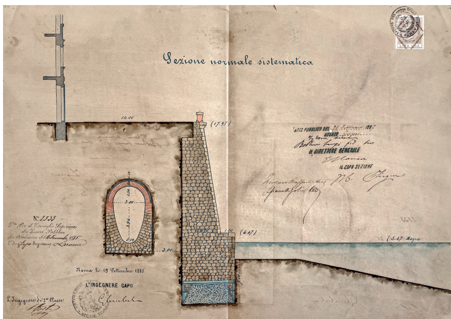
Fig. 5 – “Sezione normale sistematica”. Progetto di appalto per la sistemazione della sponda sinistra del Tevere, mediante muraglione di spallatura, nel tratto compreso dall’asse del quarto di cono tra ponte Elio e il Vicolo dello Struzzo [...], 19 settembre 1885. ASR, USTAR, b. 116.
